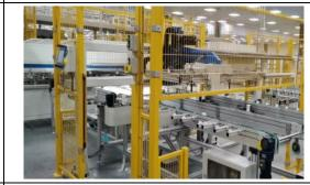
用于电池片的叠加排布,用柔性导电胶无焊 带互连,减小组件线损,减小组件热斑影 响,充分利用组件面积。
