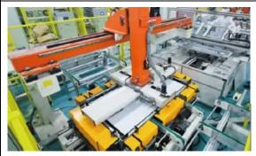
用于将层叠好的组件原材料(玻璃、 EVA/POE、晶硅电池串、背板)压合为一体。 通过自动打胶将整片光伏组件精准封装入铝 框中,并自动在四周包角。
